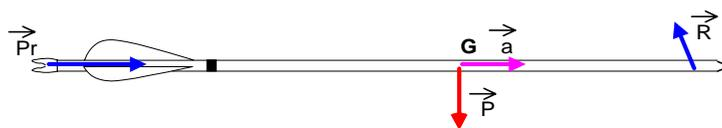
Lors de l'échappement, la force initiale de traction de la corde sur l'encoche devient force de propulsion  $\vec{P}_r$ , le poids  $\vec{P}$  reste inchangé, mais la réaction aux appuis est complétée maintenant par une force de frottement  $\vec{R}$ .
